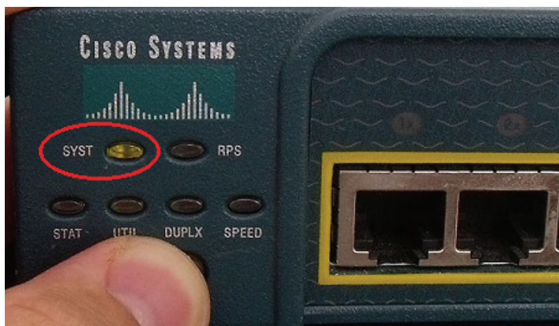
Figura 163. Leds del switch Cisco
